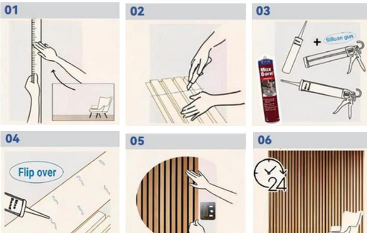
1. **Mide la pared:** Usa una cinta métrica para verificar el largo y el ancho. **Corta a la medida:** Recorta el exceso del producto según tus medidas. **Pega:** Usa pegamento o silicón para adherir el panel.
