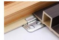
**Clip** Tamaño: 48 × 35 × 1.5 mm Este accesorio se utiliza para insertarse en una ranura y fijarse mediante pistola de clavos neumática o tornillos.
