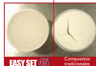
Grado de agrietamiento con espesores altos.
