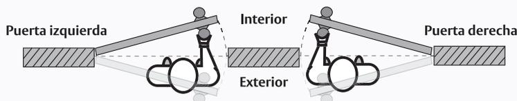
El abatimiento de la puerta se determina, colocándose en la parte EXTERIOR de la habitación y de frente a la puerta, observe de que lado se encuentran colocadas las bisagras de la puerta, si las bisagras están del lado derecho, esta puerta será DERECHA e IZQUIERDA cuando las bisagras estén del lado izquierdo.
